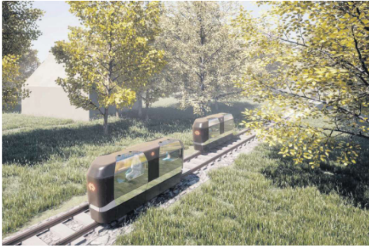
Die Kabinen des Projekts Monocab in Nordrhein-Westfalen sind so schmal, dass sie aneinander vorbeispannen.
